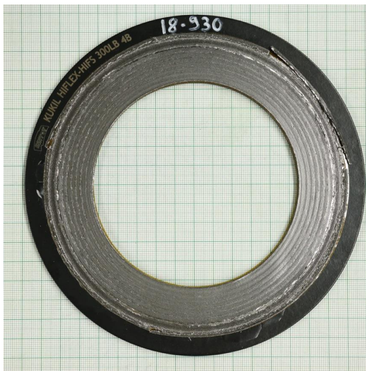
Compression test at RT (EN 13555)
