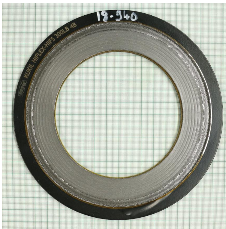
Creep relaxation test at 50 MPa - RT (EN 13555)
