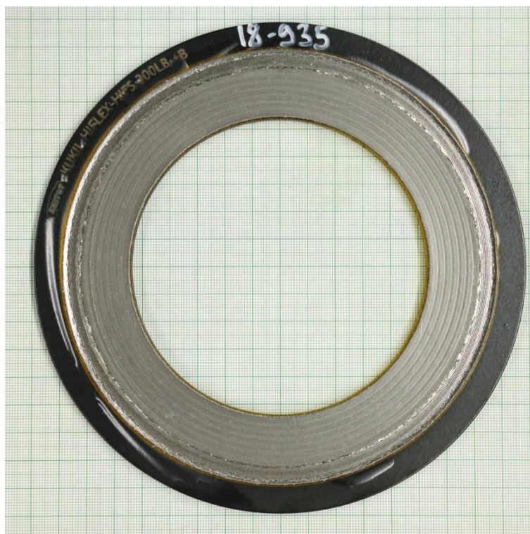
Creep relaxation test at 50 MPa - RT (EN 13555)
