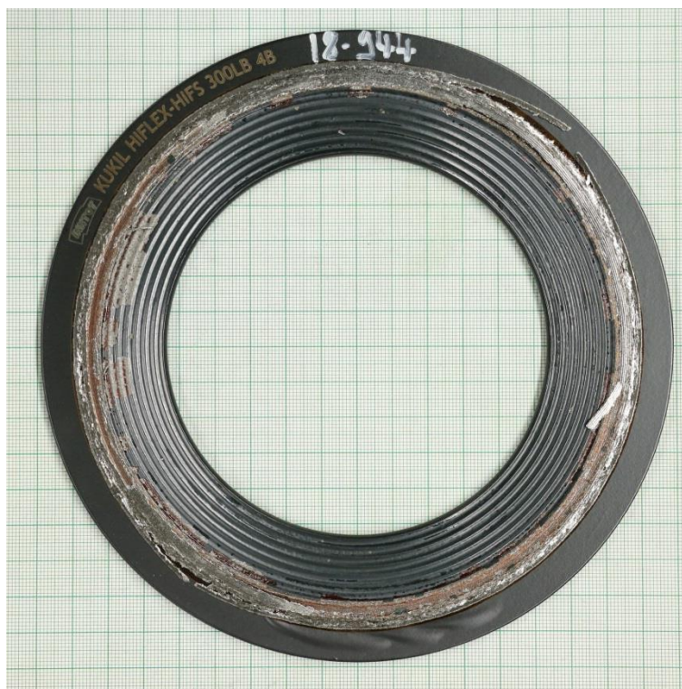
Creep relaxation test at 50 MPa - 260 °C (EN 13555)
