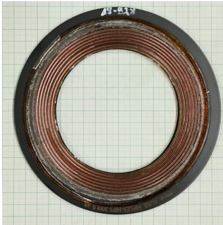
Compression test at 260 °C (EN 13555)
