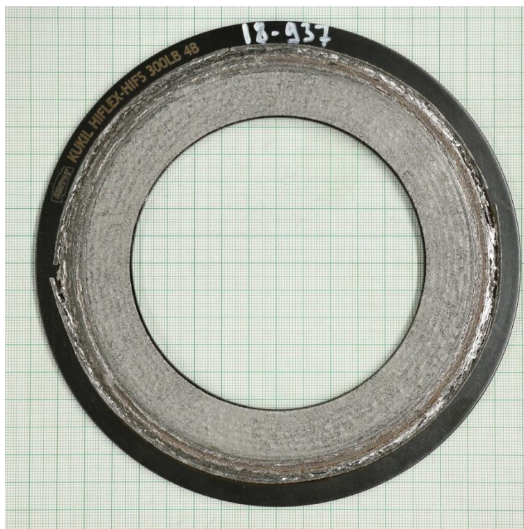
Creep relaxation test at 50 MPa - 260 °C (EN 13555)
