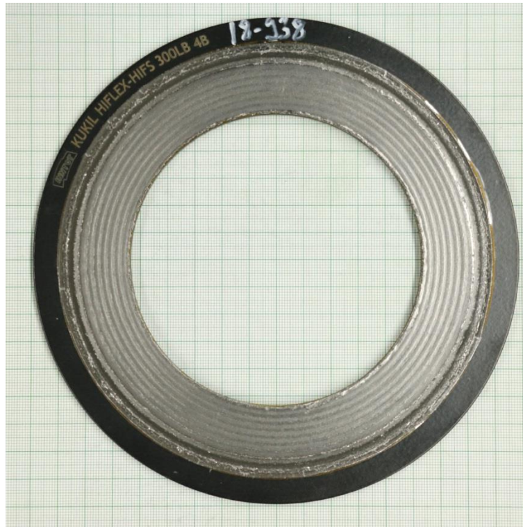
Leakage test at RT (EN 13555)
