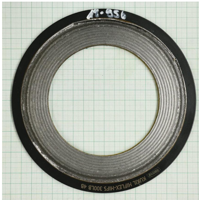
Leakage test at RT (EN 13555)
