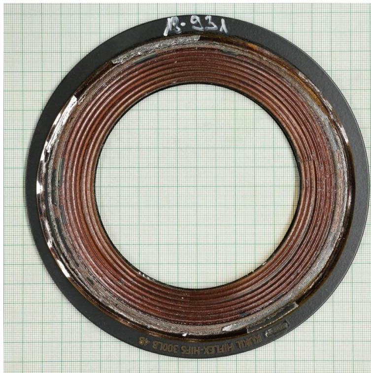
Compression test at 260 °C (EN 13555)
