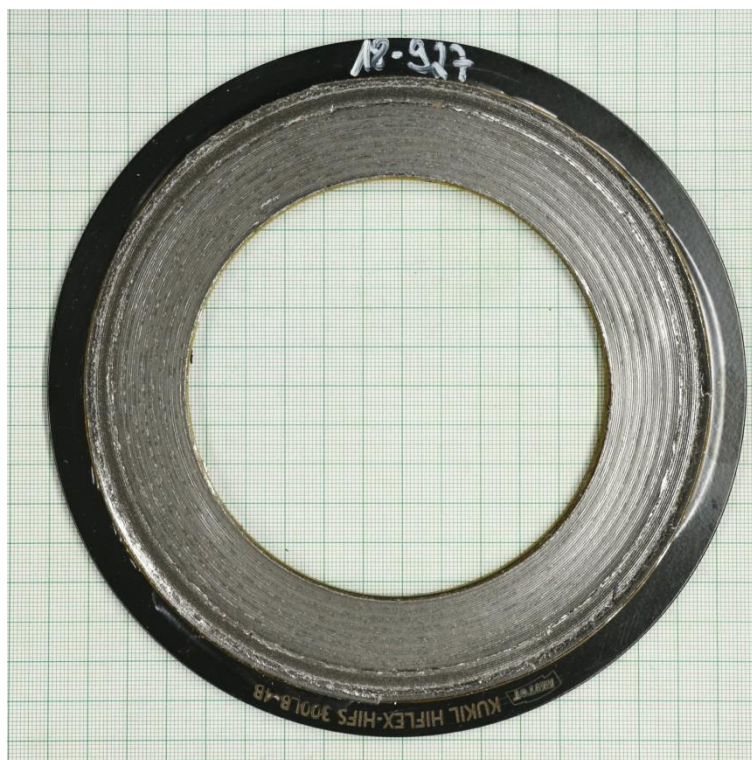
Compression test at RT (EN 13555)
